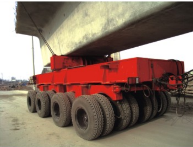
◆ 一线双桥四轴线320吨拉梁炮车(适合大吨位,长距离运输)
